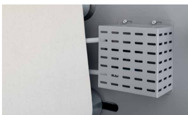
Controllo automatico del centraggio del tappeto in feltro tramite PLC
