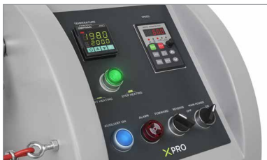
Pannello di controllo per impostare la velocità e la temperatura
