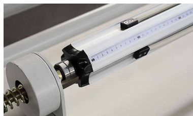
Scala millimetrata sull'albero per il corretto posizionamento del materiale
