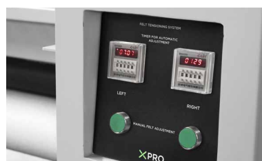
Sistema di controllo automatico del centraggio del tappeto in feltro
