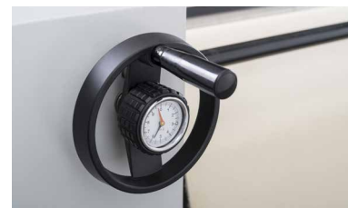
Regolazione della tensione del feltro con visualizzazione della pressione
