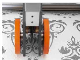
Coltello longitudinale a lama rotante singola con cuscinetto (lama doppia optional)
