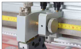
Regolazione micrometrica della posizione dei coltelli (fornita di serie)
