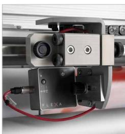
Sensore ottico per l'allineamento verticale automatico
