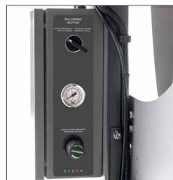
Pannello di controllo per tensionare il materiale
