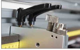
Vite di registro pressione della lama da utilizzare a seconda del tipo di materiale da tagliare
