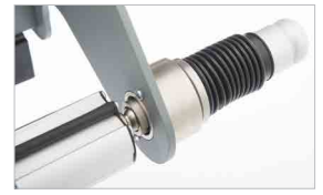
Freno albero svolgitori per regolare la tensione del materiale
