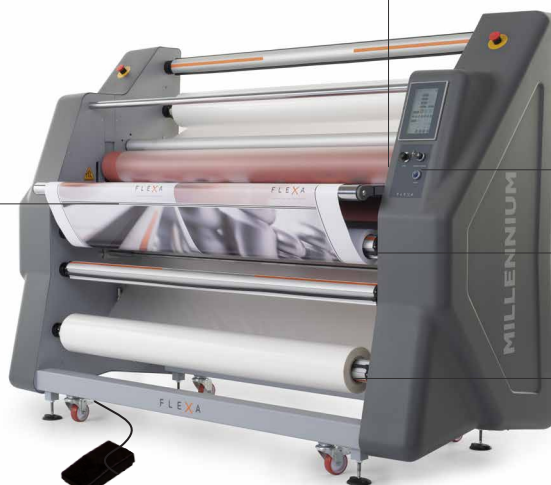
Comando di avanzamento tramite touch screen o a pedale (mani libere per la movimentazione del materiale)
