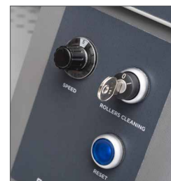
Regolazione elettronica della velocità di lavoro tramite potenziometro
