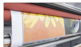
Asse riavvolgitore posteriore per ribobinare le stampe finite
