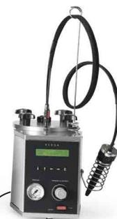
Temporizzatore multifunzione che memorizza i parametri di tempo e dosatura della resina specifica per ogni lavoro (Advanced System)
