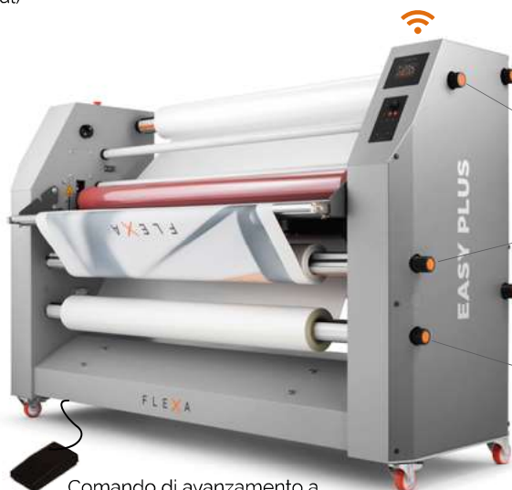
Comando di avanzamento a pulsantiera o a pedale (mani libere per la movimentazione del materiale)
