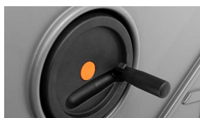
Sollevamento manuale del rullo superiore con volantino (sollevamento motorizzato optional)
