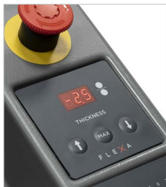
Sollevamento motorizzato del rullo superiore (optional)
