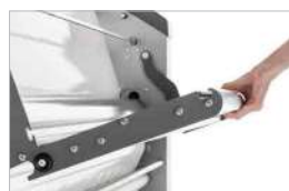
Piano di lavoro anteriore basculante per facilitare il set up della macchina
