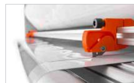
Nuovi coltelli con lama protetta per rifilare il materiale laminato senza rischi per l'operatore
