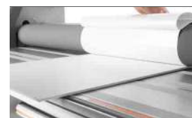
Piano maggiorato in alluminio ideale per il montaggio dell'immagine sul pannello
